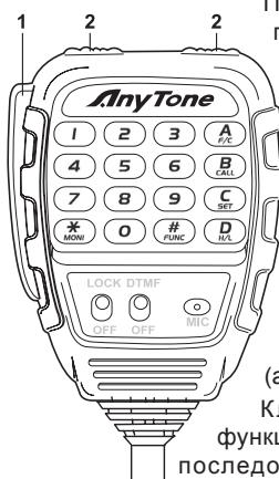
Переключатель DTMF (ON/OFF): Когда переключатель находится в положении DTMF, цифры от 0 до 9, буквы от A до D, а символы \* и # используются для генерации DTMF тонов. Когда переключатель находится в положении ВЫКЛ, цифровые клавиши могут быть использованы для прямого выбора каналов, буквы и символьные клавиши используются для выполнения следующих функций устройства:
